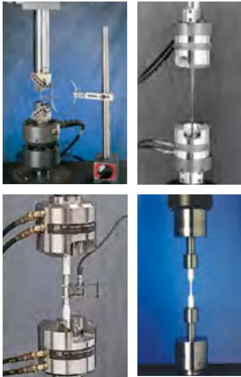
MTS Bionix桌面式力学测试系统的附件包括夹具、工装、压盘、盐浴等附件，适用于灵活多样的生物医学工程力学测试需要。
